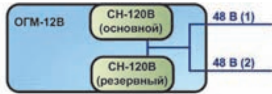
Рис. 3. Дублирование преобразователей напряжения в ОГМ-12В
