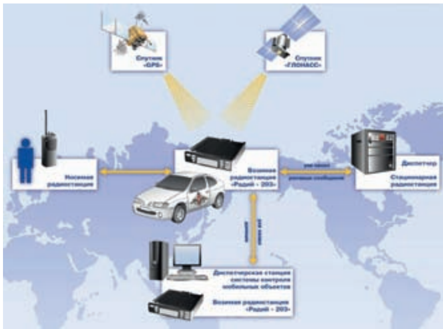
СКМО на базе радиостанции «Радиус-203»
