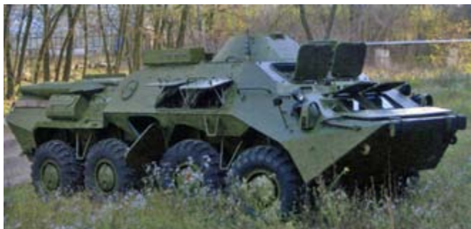
Электростанция Э-351 БрМ1
